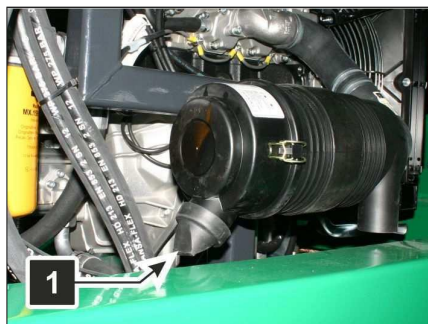
Fig. 6 Filtrul de aer, supapa de praf
