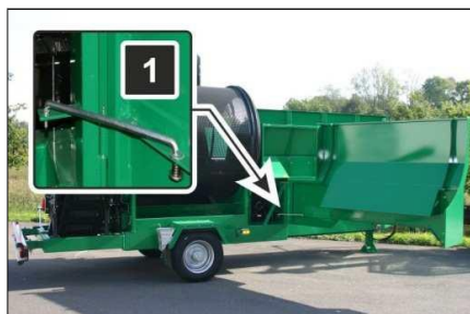
Fig. 54 Închizători, asigurarea peretelui lateral
