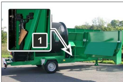
Fig. 30 Sculă, schimbare segmente de sită
