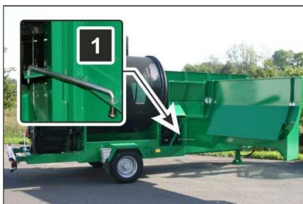
Fig. 37 Închizători, asigurarea peretelui lateral
