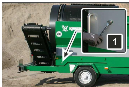
Fig. 8 Închizători, deschiderea peretelui lateral
