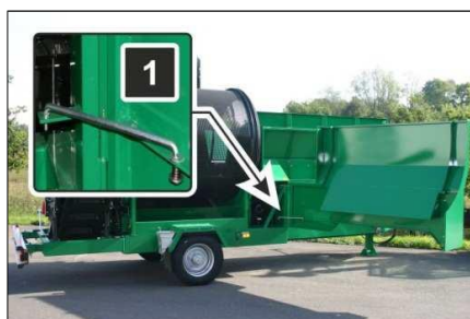
Fig. 9 Închizători, asigurarea peretelui lateral
