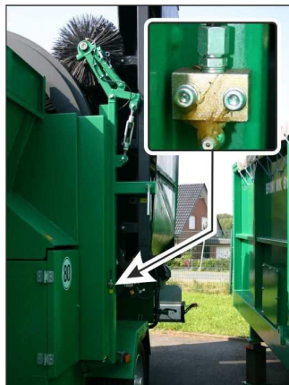
Fig. 14 Blocuri de gresare centralizată 1
