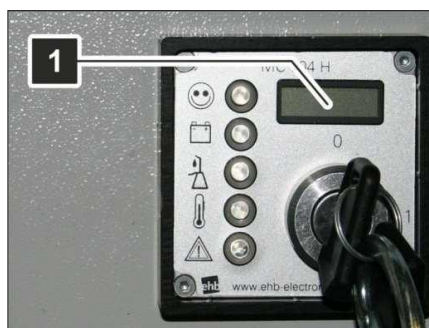
Fig. 12 Modulul de pornire, contorul orelor de funcționare
