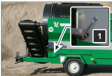
Fig. 28 Închizători, deschiderea peretelui lateral
