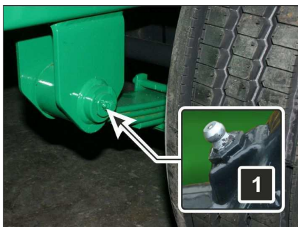
Fig. 16 Mecanismul de rulare - punctele de gresare 1
