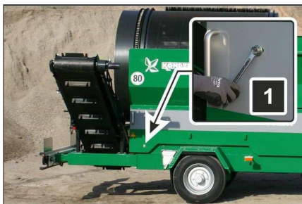
Fig. 36 Închizători, deschiderea peretelui lateral
