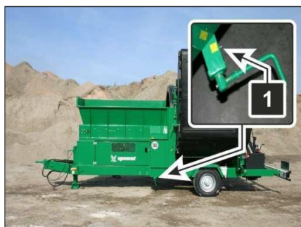
Fig. 19 Punctele de gresare - manivela frânei
