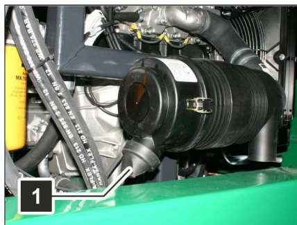
Fig. 23 Filtrul de aer, supapa de praf
