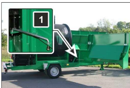
Fig. 29 Închizători, asigurarea peretelui lateral
