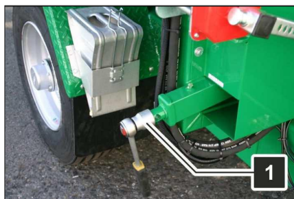
Fig. 33 Detensionarea lanțului de acționare
